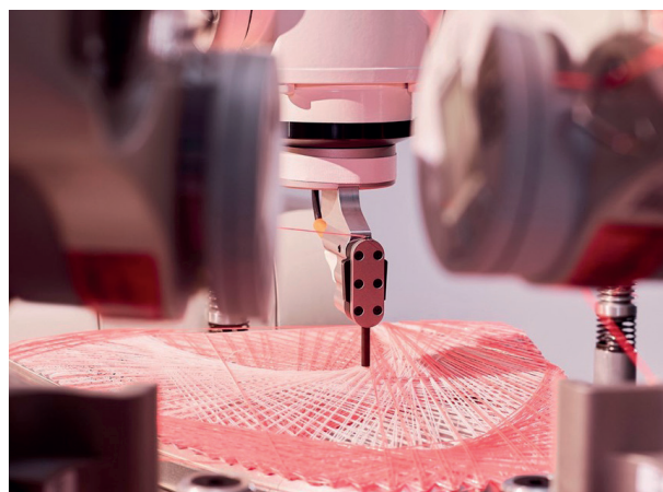
Figure 7 : Prototype de chaussure de sport FUTURECRAFT.STRUNG et robot multitâche procédant à sa fabrication
